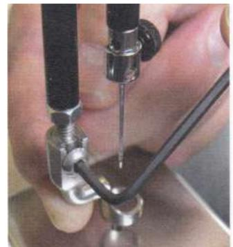
3. 取り付けした押え金の中心と針板の針穴を見比べて、針穴が押え金の真ん中に位置していることを確かめます。もしずれていたら、付属品のスパナレンチ(写真左)を使って押え金の上にあるナットを緩めて穴の位置と押え金の位置を合わせます。押え金が回らないようにしっかりと持ってスパナレンチでナットを締め付けて位置を修正します。(写真左)
