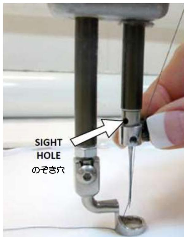
☞ 重要：針を交換した後、「のぞき穴」見て針の先端がストップ位置まで挿入されていることを確認してください。針が中途半端に取り付けられていると、目飛びや糸絡みの原因となりますし、時には針が折れてキルトや、内部部品を傷つけかねません。
