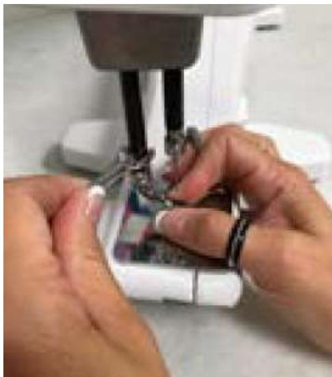
2.5mm L 型六角レンチを使ってネジを締め付けます。針が押え金の中心にあることを確かめます。(写真右下)
